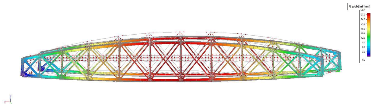
Obr. 44 Průhyb zesílené konstrukce od zatížení modelem C2
